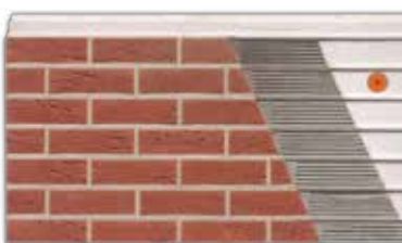
Vytváření systému přeběžného spárování prostřednictvím předem vytvarovaných PS desek.
